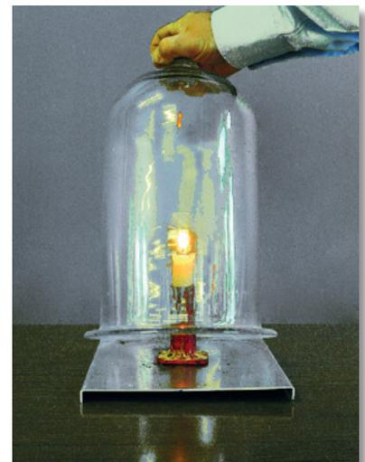
Bei geringer Luftzufuhr kann sich die Verbrennung u. U. „auf kleiner Flamme“ fortsetzen. Plötzliche Luftzufuhr führt dann zum schnellen Aufflammen.
